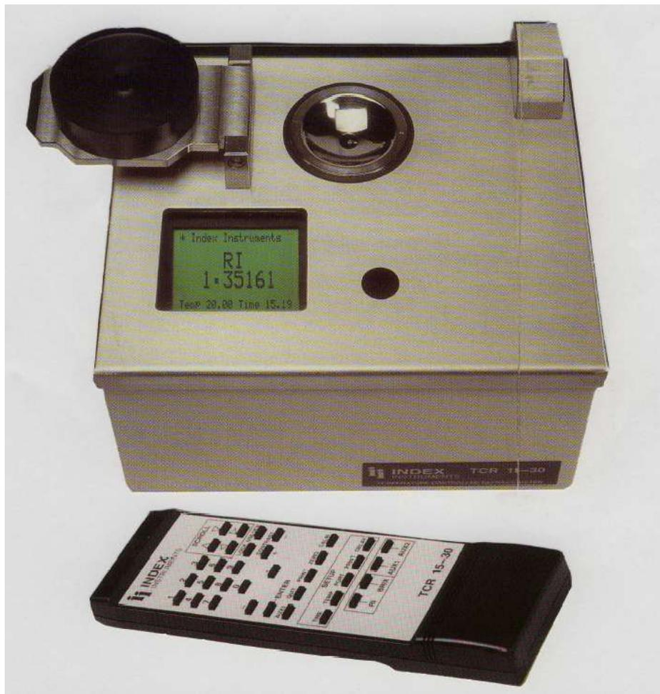
Eine Fernbedienung ersetzt das herkömmliche Bedienfeld eines Refraktometers, damit wird ein sicherer Zugang zu den Analysenparametern gewährleistet. Sind diese einmal eingegeben, können sie nicht mehr durch nicht autorisiertes Personal z. B. im Produktionsprozess geändert werden. Somit kann die Fernbedienung von der verantwortlichen Person verschlossen und erst wieder benutzt werden, wenn die einzelnen Parameter einer Änderung bedürfen.
